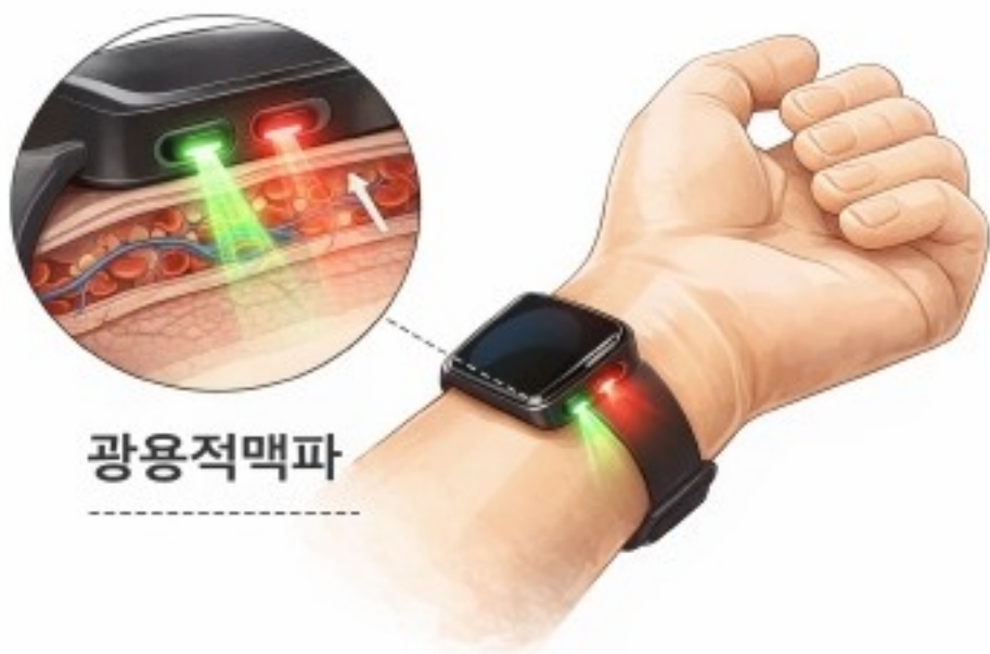
[이미지] 광용적맥파(PPG) 측정 원리 개념도. 스마트워치의 빛으로 혈류 변화를 감지해 심박수를 측정한다.(챗GPT 이미지)
